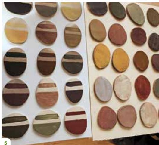
5: Zum Vergleich: Rechts Tonplatten mit Steinpigmenten, links jene mit synthetischen Pigmenten gebrannt.
